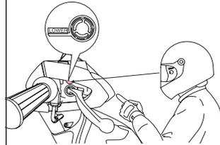
평평한 장소에서 메인스텐드로 세우고 핸들을 움직여, 마스터 실린더 보디 캡의 상면을 수평으로 합니다. 또는 차체를 수직으로 하고 브레이크 액면이 레벨 라인에 수평한 상태로 합니다.
