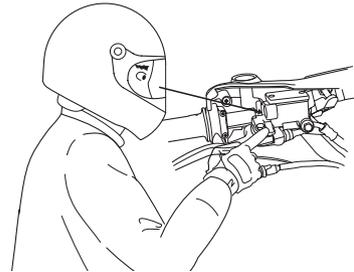
평평한 장소에서 메인스탠드로 세우고 핸들을 움직여, 마스터 실린더 보디의 상면을 수평으로 합니다. 또는 차체를 수직으로 하고 브레이크 액면이 레벨 라인에 수평한 상태로 합니다.
